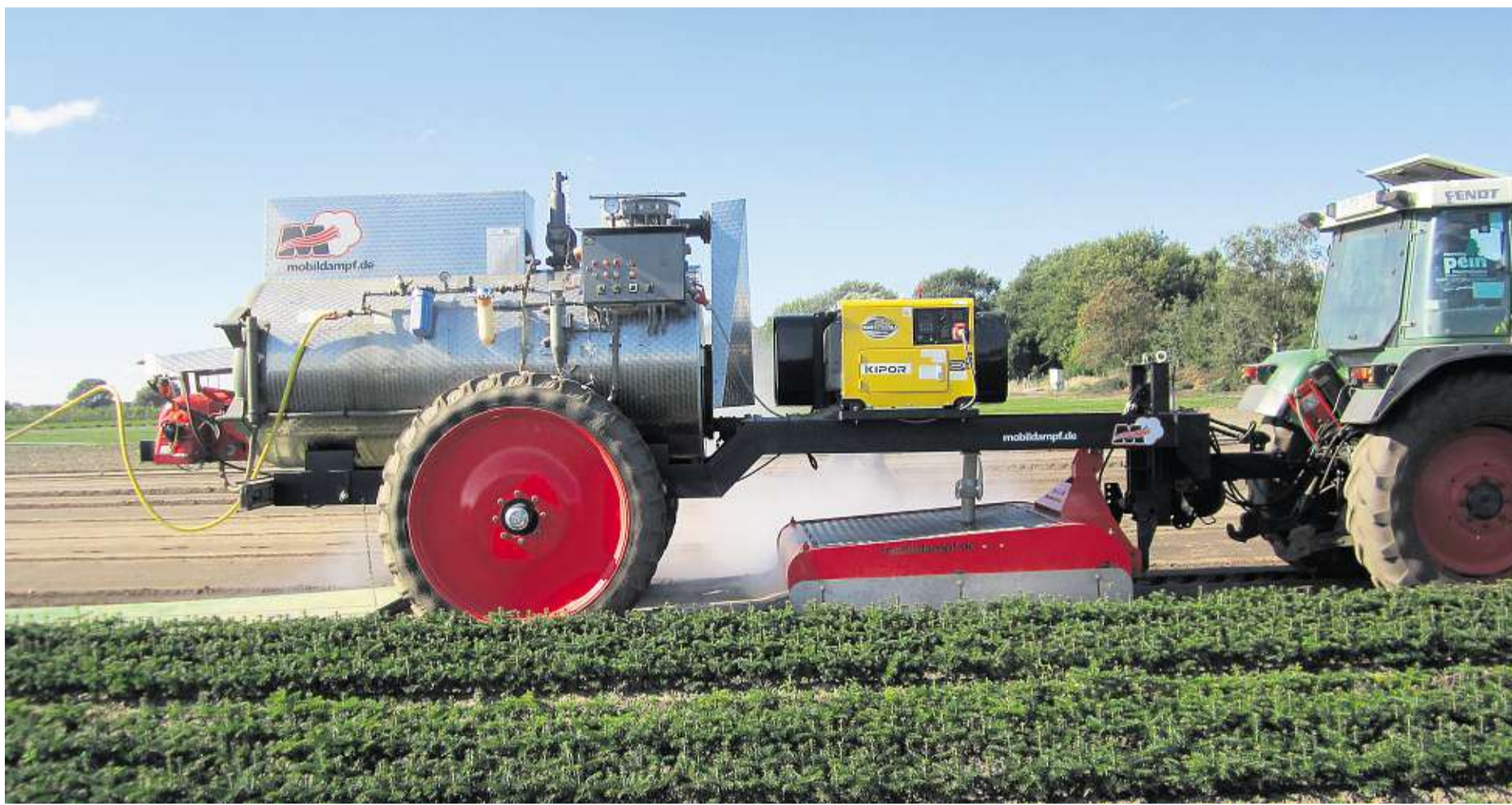
Diese mobile Dampfmaschine, die heißen Dampf in die Böden presst und so Schädlinge abtötet, war vor zwei Jahren in Appen im Einsatz. Fotos: dampf.de Steffen Klein/Fuchs
